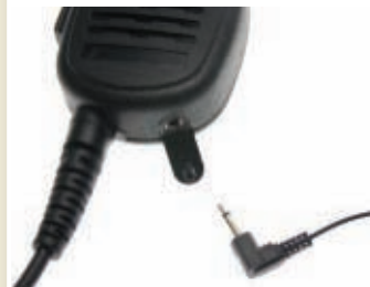
CONEXIÓN ALTAVOZ EXTERIOR VALIDO PIN09 y PIN10
